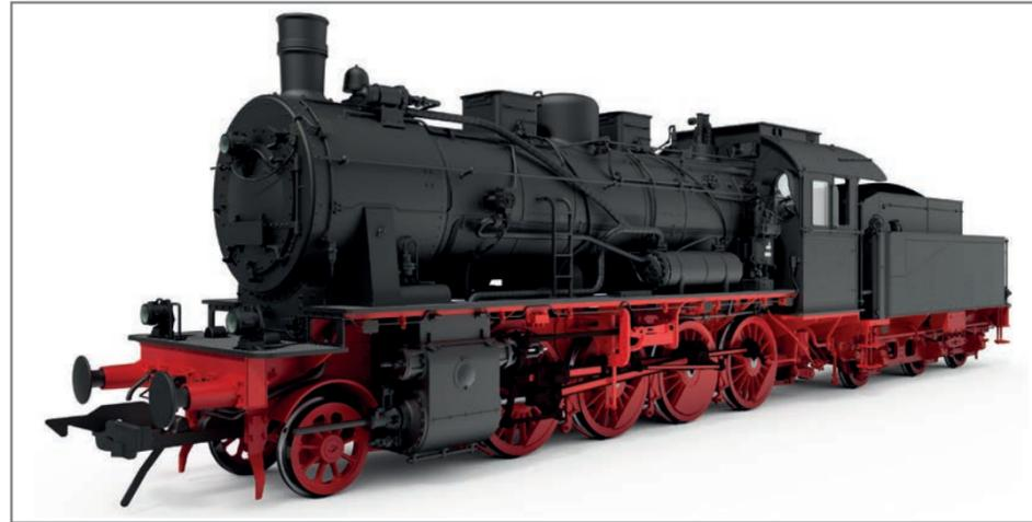
Die G 8.1 wurde ab 1913 aus der seit 1902 gebauten G 8 weiter entwickelt. Bei gleicher Höchstgeschwindigkeit von 55 km/h stellte die G 8.1 eine Leistung 1.260 PSi statt 1.100 PSi zur Verfügung.
